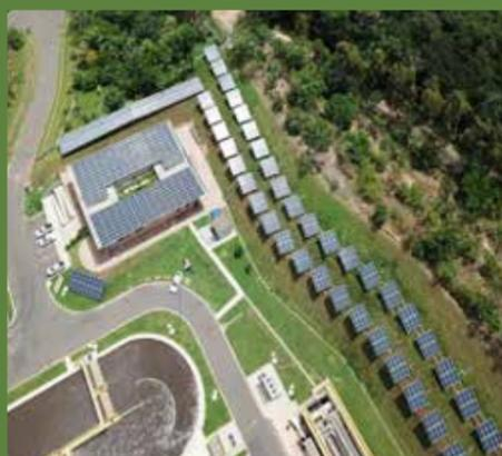
Parte do tratamento de águas residuais da ETE será realizado por meio do uso de energia solar. Para a geração dessa energia renovável, os painéis fotovoltaicos contam com a tecnologia PERC (Passivated Emitter and Rear Cell), que gera energia de forma mais eficiente que outros painéis fotovoltaicos.
